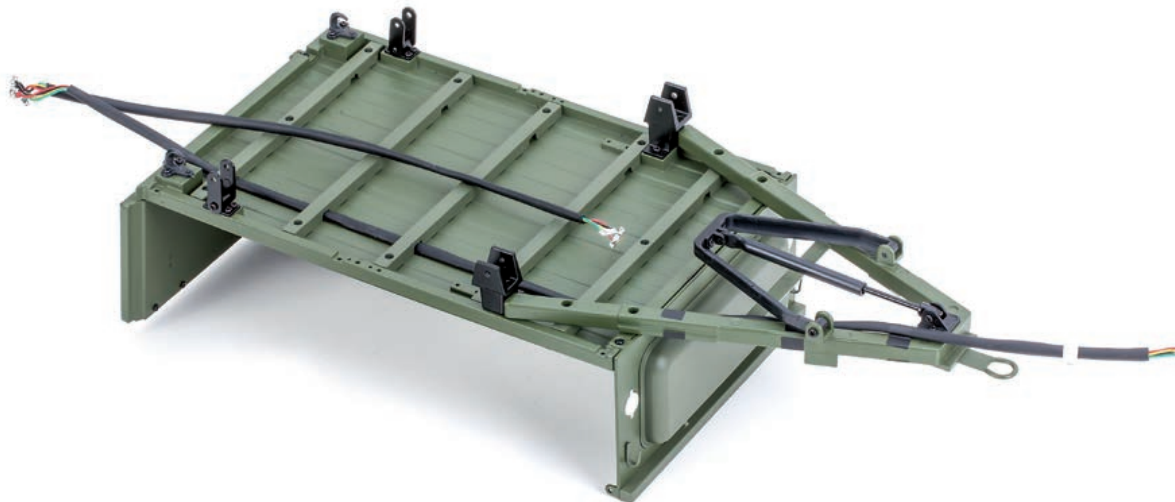
Шаг 6. Аналогичным образом при помощи винта 1,7×5 (DM) закрепите второй кронштейн рессоры в правой части пола кузова прицепа (позади дышла).
