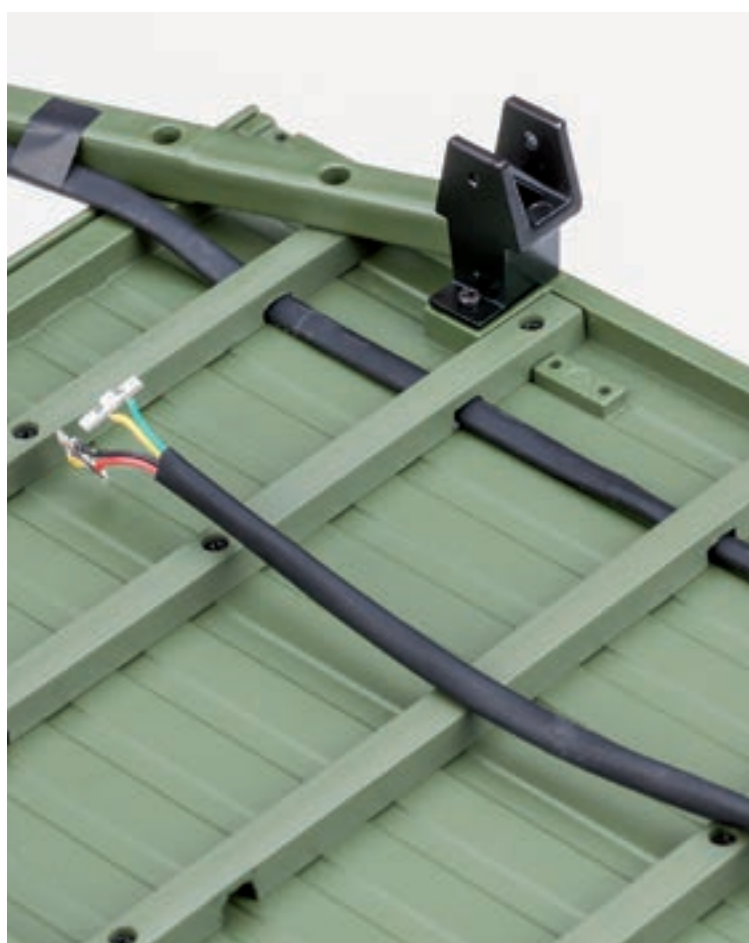
Шаг 5. Установите передний кронштейн рессоры на нижней плоскости пола кузова прицепа (в левой части), позади ранее установленного дышла. Совместите центровочные и крепежные элементы кронштейна и пола кузова. Закрепите кронштейн на полу винтом 1,7×5 (DM).
