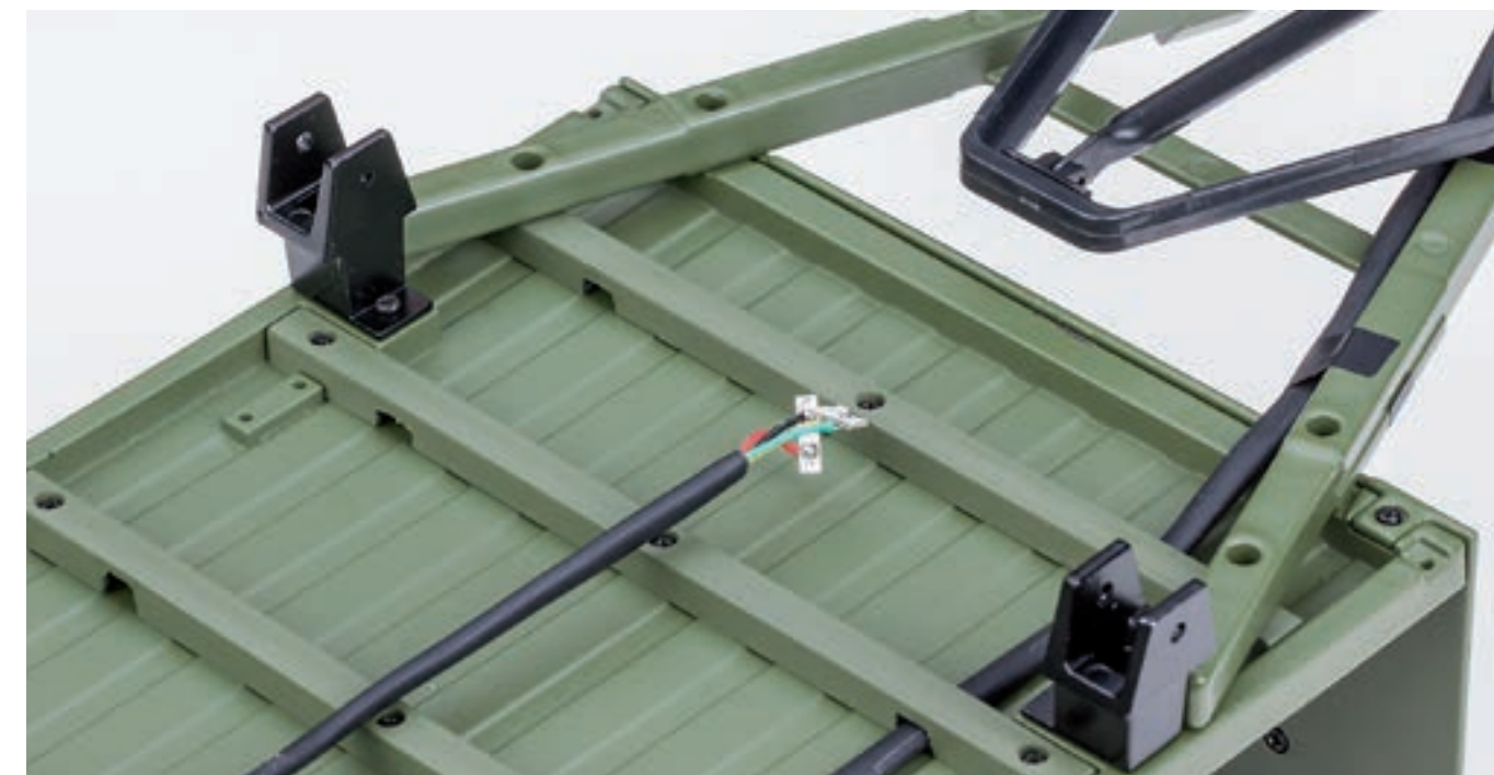
Шаг 6. Аналогичным образом при помощи винта 1,7×5 (DM) закрепите второй кронштейн рессоры в правой части пола кузова прицепа (позади дышла).
